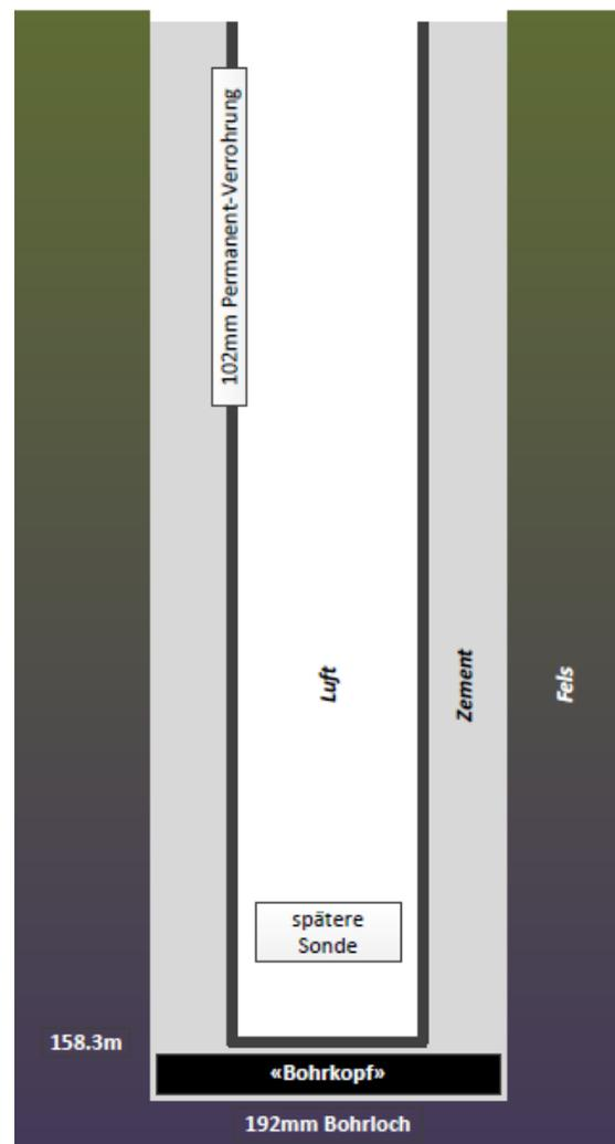
Fig. 6: Nicht-massstäbliche Skizze des finalen Ausbauszustand der Bohrung BOeB-1 nach deren Fertigstellung am 21.11.13. Nicht dargestellt ist die Verfüllung der obersten etwa 13.5 m des Ringraums mit Bentonit-Pellets.
