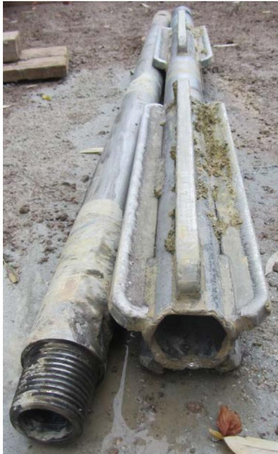
Fig. 4: Foto des am 15. November 2013 geborgenen Gestänge-Stücks (am Foto rechts) mit sichtbarer Bruchfläche unterhalb des Zentrierers bzw. Räumers.
